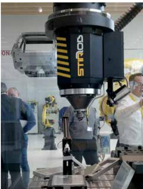
L'utensile fermo in posizione durante l'intera lavorazione, è stato utilizzato un robot Fanuc M-900iB/700, un 6 assi rigido e preciso che permette di esercitare la forza richiesta dalla FSW e ha la caratteristica di essere dotato di un doppio sistema di misura con encoder montati sia sui motori che sui giunti, necessaria per garantire pressione e precisione. Il potente controllore R30-iB Plus assi-
